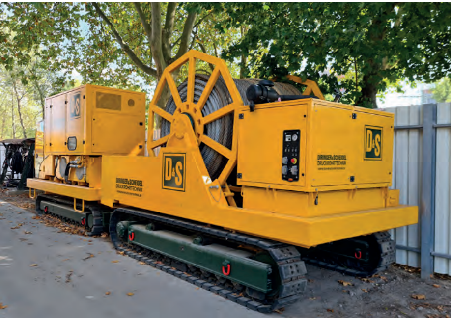
100t Seilwinde für Rohreinzug
